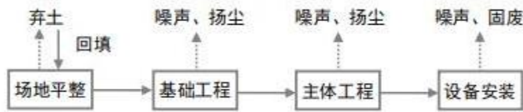
图 2-2 施工期工艺流程及产污环节图
